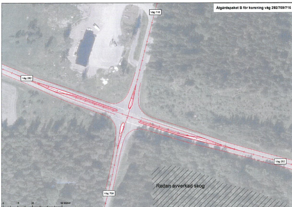
Figur 15. Åtgärds paket B för korsning väg 292/709/716. Steg 3-åtgärd målade mittrefuger och vänstersvängfält.
